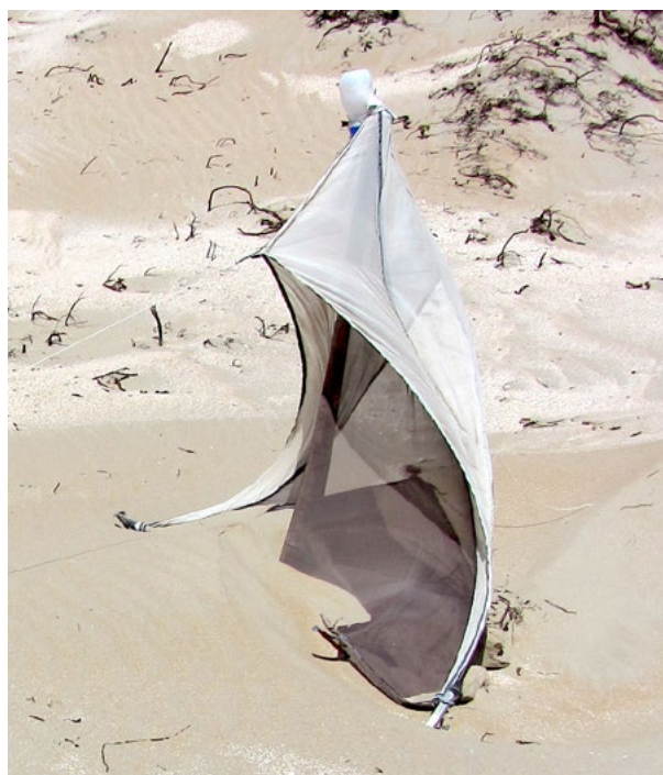
Afb. 21: Eenstoks-malaiseval op stuivende paraboolhelling. De onderste zoom van het verticale, donkere gaas stond oorspronkelijk strak gespannen tussen de twee grondpennen. Aan weerszijden van de verticale stok heeft het stuifzand de val gedeeltelijk bedolven. (foto: Jeroen de Rond 2015)
